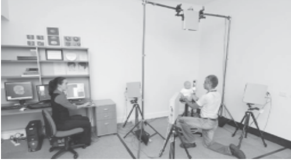
Figura 1 - Sistema de fotografia 3D com cinco unidades modulares.
